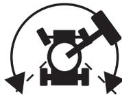
Halten Sie zum Fahren den Schalter Antriebsaktivierung nach links oder rechts, und bewegen Sie langsam den Steuerhebel Fahren aus der Mittelstellung.
